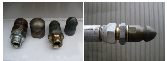
Sistema desatascado de lodos tipo topo
