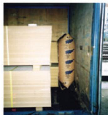
Figura 29: Colchón de aire para bloqueo lateral
