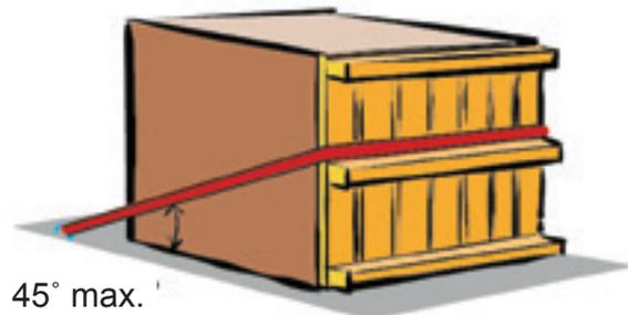
El amarre con resortes puede realizarse de muchas formas. No obstante, si no se aplica el amarre al borde superior del elemento de la carga, los límites de inclinación del peso de la carga se reducen.
