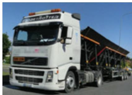
**Figura 14: Chapas de acero transportadas a 45°**
