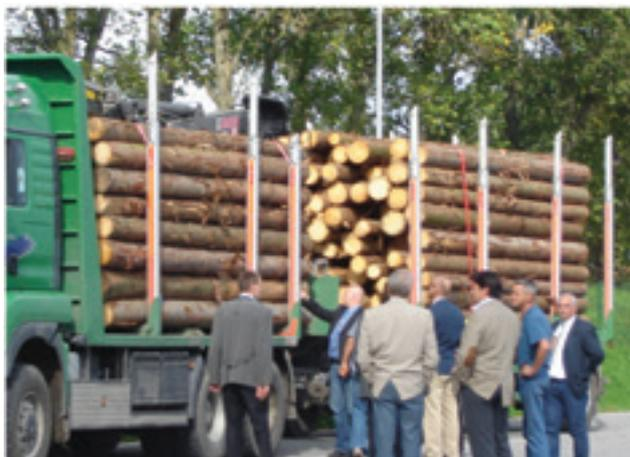
**Figura 51: Sujeción de madera en troncos**
