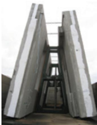
**Figura 46: Bastidor móvil en forma de A**
