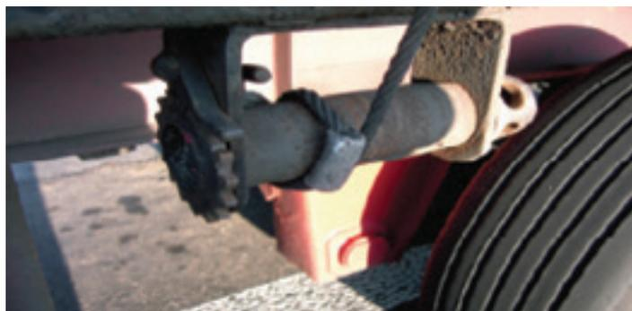
**Figura 24: Cable de acero tensado con torno**
