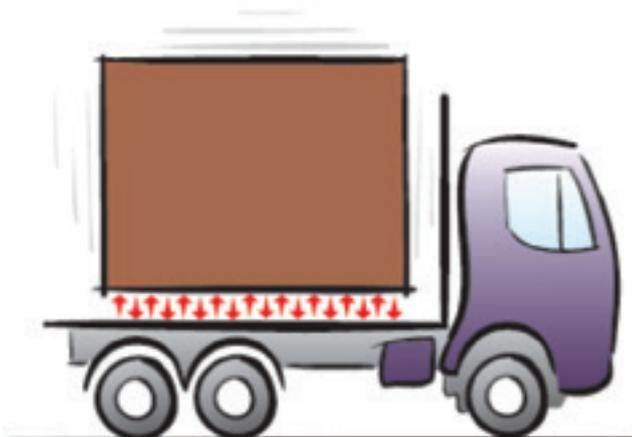
Figura 3: Vibración vertical durante la conducción
