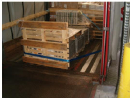
**Figura 75: Disposición de las sujeciones en la parte posterior para cargas combinadas**
