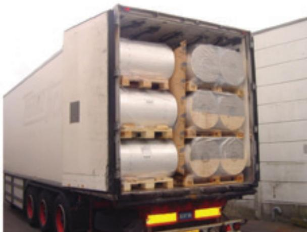
Figura 28 Relleno entre las filas de carga
