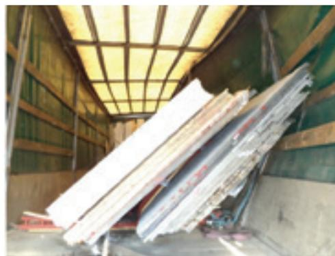
**Figura 45: Bastidor en forma de A contraído**
