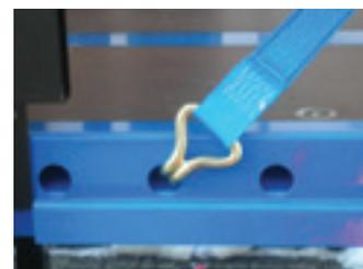
**Figura 13: Orificio de anclaje en el perfil lateral**
