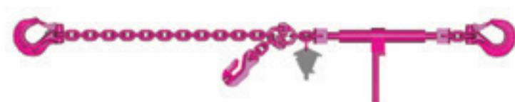
En la norma EN 12195-3 se describen las cadenas que pueden utilizarse para sujetar la carga en el transporte por carretera. Suelen ser cadenas de eslabón corto con gan-
