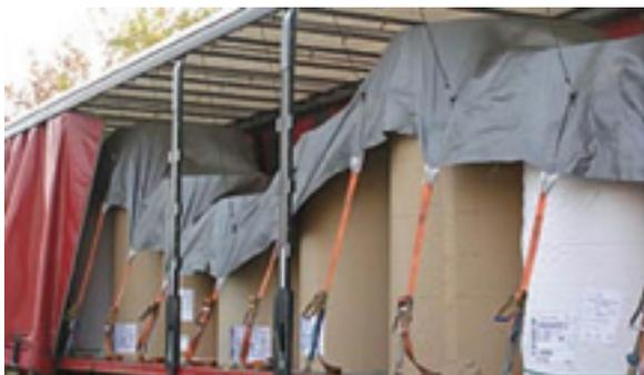
**Figura 31: Sujeción con cubierta**
